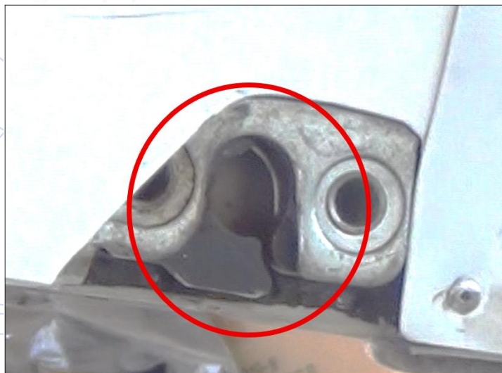
Cârlig prindere poziția închisă
